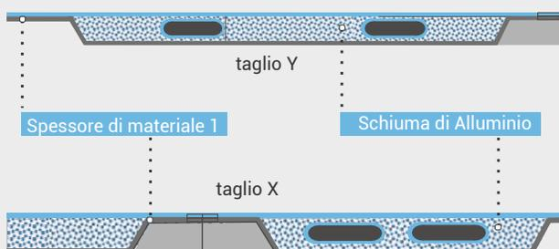
*Sandwiches in schiuma di alluminio con profili integrati per il raffreddamento della batteria*
