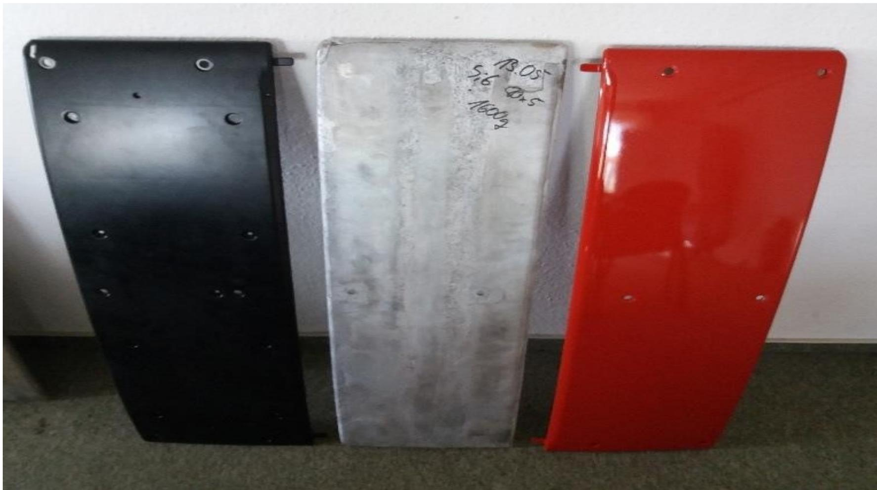
Archi del tetto del veicolo realizzati in pura schiuma di alluminio Havel Lite®
