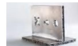
Ulteriori opzioni di lavorazione: foratura, saldatura, fresatura
