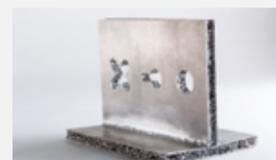
Ulteriori opzioni di lavorazione: foratura, saldatura, fresatura
