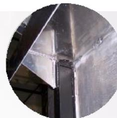
Connessione mediante processo MSG (Al-Al) e profili di saldatura sabbati (Al-Acciaio)
